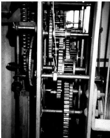
Afb. 3. Hierdoor zijn de assen met de tandwielen van het gaand- en slagwerk bij uurwerken met deze opbouw beduidend korter dan wat algemeen gebruikelijk is.
