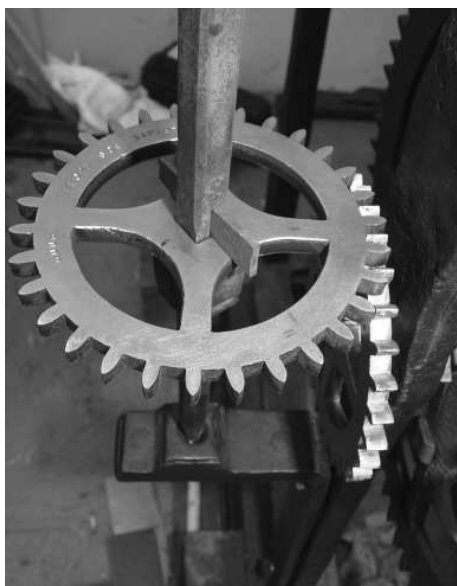
Afb. 1. Authentiek uitziende nieuw gesmede verticale uuras voorzien van op moderne wijze vervaardigde tandwielen.
