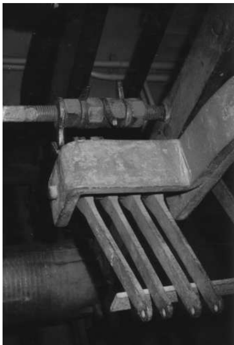
Afb. 15. Hoewel het speelwerk een aantal “moderne” elementen bevat, o.a. de moeren, is mogelijk toch van oorspronkelijke assen gebruik gemaakt.
