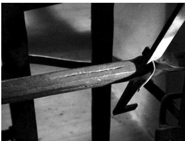
Afb. 12. De vierkante assen vertonen diepe naden; het lijkt alsof ze gemaakt zijn van gevouwen platijzer.
